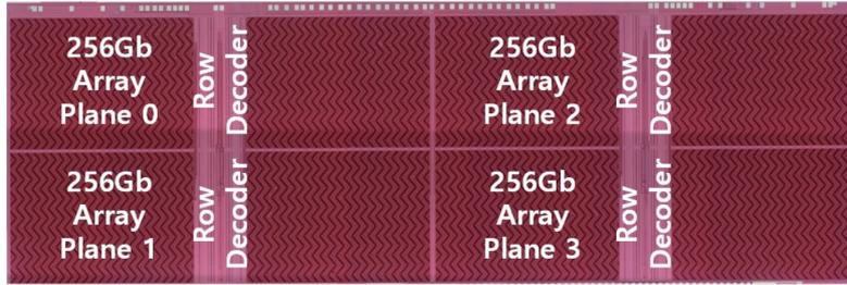
[그림 2] 300층 이상으로 구현된 1Tb TLC 3D NAND flash
